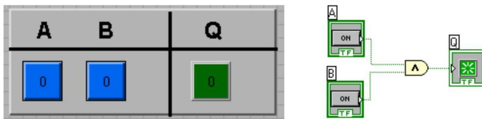
Рисунок 19 - Функция LabView «И», присоединенная к входным и выходному терминалам
