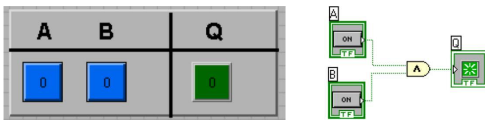
Рисунок 8.18 - Функция LabView «И», присоединенная к входным и выходному терминалам
