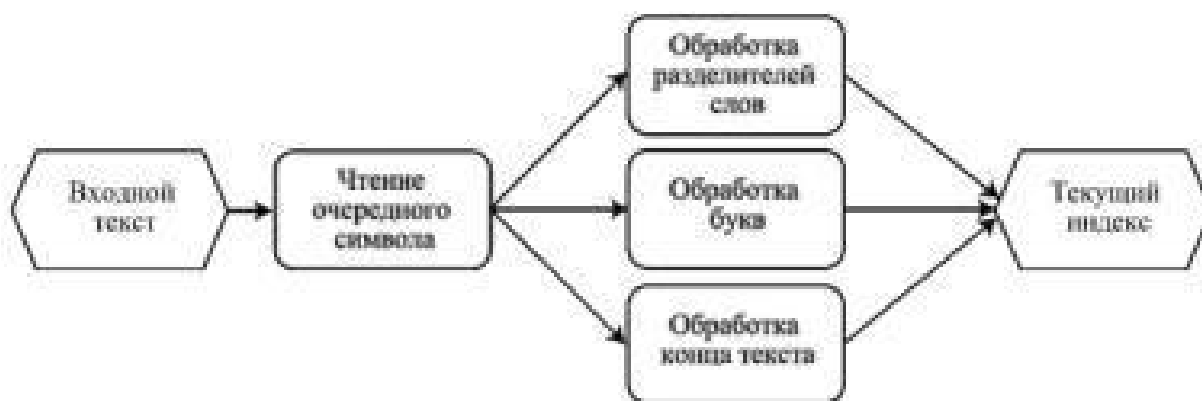
Рисунок 11 - Архитектура индексатора в стиле репозитория
